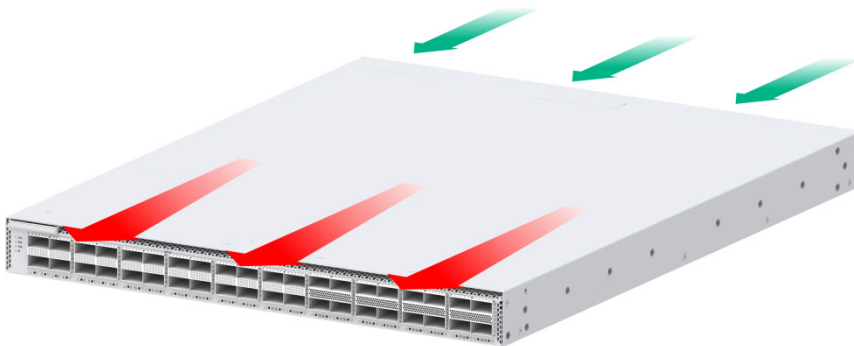
图6-4 电源侧进入端口侧排出散热空气流向示意图（以 S9600XP-24B16DH-G 为例）
